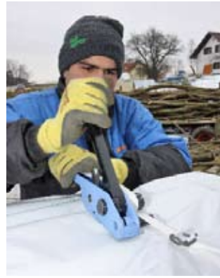
Mit dem Haspelspanngerät werden die Bänder gespannt.
