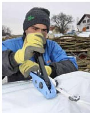
*Mit dem Haspelspanngerät werden die Bänder gespannt.*
