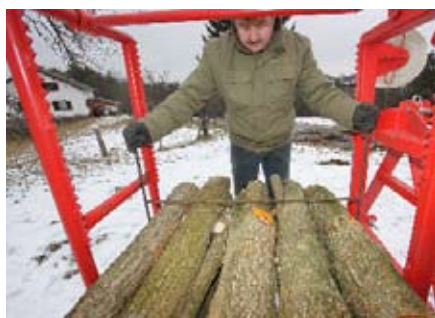
In die Mitte des Stapels kommt ein Zugstab zu Stabilisierung.
